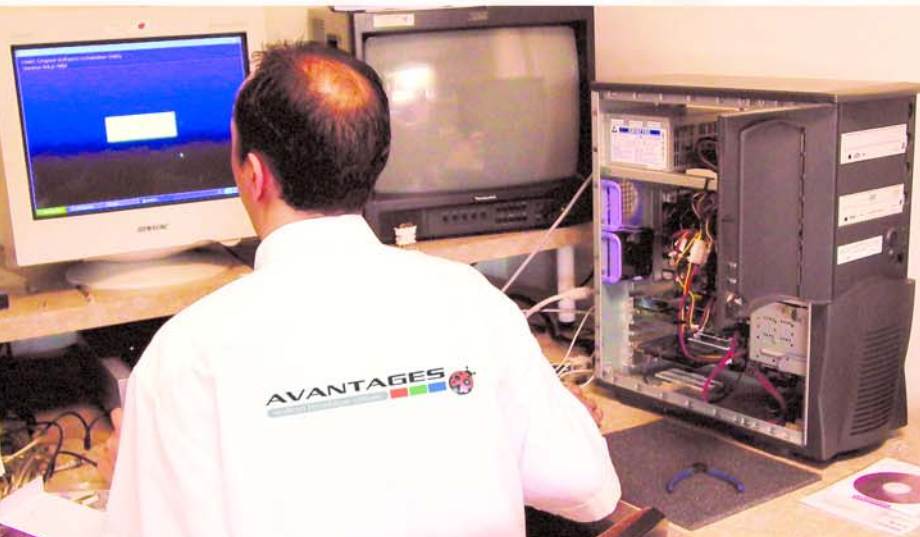
Assemblage et configuration matérielle et logicielle d'une station sur base Matrox RT.X100 Xtreme sous Windows.
